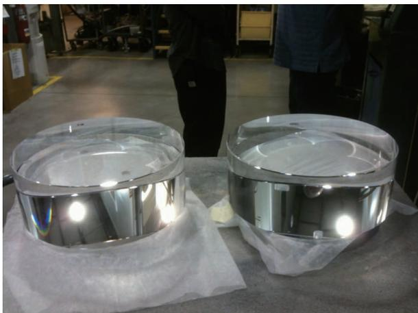
图3 LIGO使用的镜子的照片<sup>[5]</sup>
